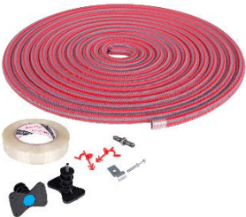
Injektointipakkaus Intec® 100 m pakkaus sisältää: Intec® Premium injektointiletku 100 m, muottikartiot 30 kpl, muovikiinnike painettava 500 kpl, metallikiinnike naulalla 300 kpl, letkuliitin 20 kpl, kuituteippi 1 rll
